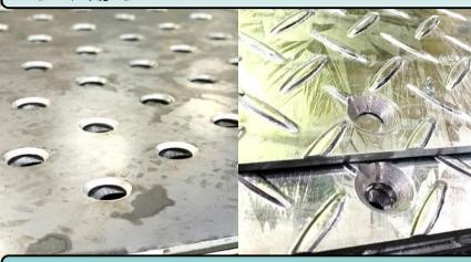
今回は板の穴加工の紹介です。 大きな板、穴数が多いもの、しま板 への皿穴加工も行っています。 しま目が穴と被ってしまっている部 分も滑らかに仕上げることが可能で
